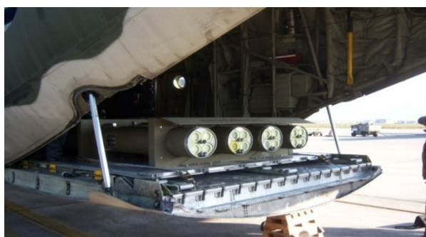
Σύστημα άφησης φωτοβολίδων (σχεδίαση ΕΤΗΜ)
