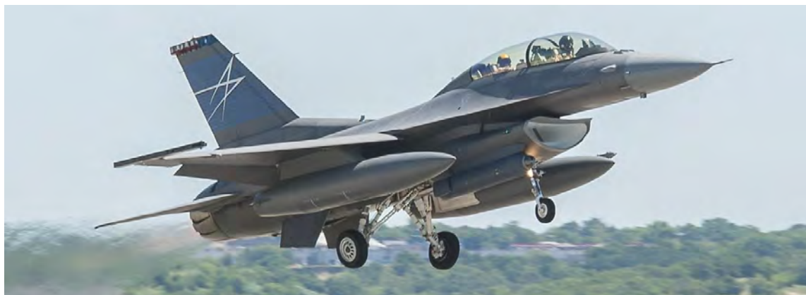
Εικόνα 2: Α/Φ F-16 εκτελεί πτήση δοκιμής με το σύστημα IRST Legion Pod της Lockheed Martin, ενώ πρόσφατα και η Northrop Grumman πρότεινε το ανάλογο σύστημα OpenPod ( http://www.lockheedmartin.com/us/news/press-releases/2015/june/mfc-063015-lockheed-martin-legion-pod.html )
