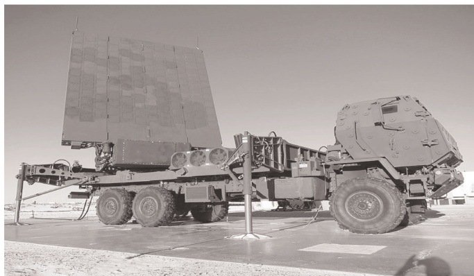
Εικόνα 2: Το ραντάρ επιτήρησης UHF του (υπό ανάπτυξη) αντιαεροπορικού – αντιβαλλιστικού συστήματος MEADS, το οποίο καλύπτει 360° αποκαλύπτοντας στόχους σε μεγάλες αποστάσεις, τους οποίους αναθέτει στο ραντάρ ελέγχου πυρός που λειτουργεί στην X-Band, για καθοδήγηση πυραύλου εναντίον τους ( www.meads-amd.com ).
