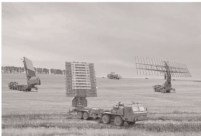
Εικόνα 5: Το ρωσικό σύστημα NEBO-M το οποίο περιλαμβάνει 3 διασυνδεδεμένα ραντάρ, στις μπάντες VHF, L και S/X, καθώς και έναν σταθμό σύντηξης δεδομένων. Ο
