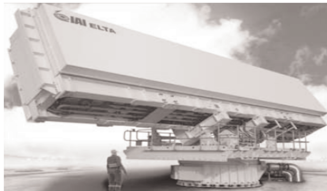
Εικόνα 3: Το ραντάρ έγκαιρης προειδοποίησης ELM-2090U UHF ULTRA της ισραηλινής IAI-ELTA, το οποίο μπορεί να αποκαλύψει στόχους χαμηλού RCS και βαλλιστικούς πυραύλους σε αποστάσεις άνω των 500 km. Ανάλογα με την απαιτούμενη λειτουργία και επιδόσεις, μπορεί να αποτελείται από 1 ή 6 ή 22 στοιχεία (cluster). Στην εικόνα φαίνεται το σύστημα C6, με 6 στοιχεία ( www.iai.co.il ).
