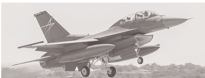
Εικόνα 10: Α/Φ F-16 εκτελεί πτήση δοκιμής με το σύστημα IRST Legion Pod της Lockheed Martin, ενώ πρόσφατα και η Northrop Grumman πρότεινε το ανάλογο σύστημα OpenPod ( http://www.lockheedmartin.com/us/news/press-releases/2015/june/mfc-063015-lockheed-martin-legion-pod.html )
