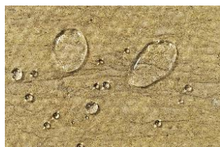
Εικόνα 5: Ο Πετροβάμβακας ως υδρόφοβο υλικό δεν απορροφά νερό
