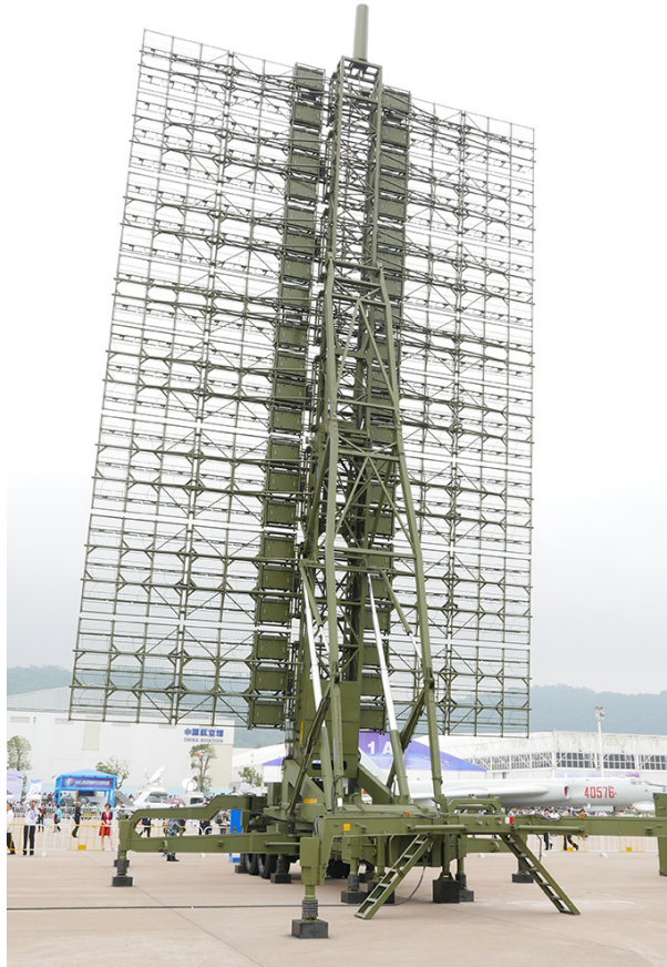
Εικόνα 4: Το ραντάρ CETC JY-27A Skywatch-V , το πρώτο κινεζικό ραντάρ VHF AESA, στην έκθεση αεροναυτικού υλικού Zhuhai στην Κίνα, το Νοέμβριο 2014 ( http://aviationweek.com/technology/new-radars-irst-strengthen-stealth-detection-claims ).
