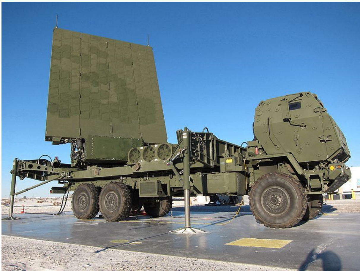
Εικόνα 2: Το ραντάρ επιτήρησης UHF του (υπό ανάπτυξη) αντιαεροπορικού – αντιβαλλιστικού συστήματος MEADS , το οποίο καλύπτει 360° αποκαλύπτοντας στόχους σε μεγάλες αποστάσεις, τους οποίους αναθέτει στο ραντάρ ελέγχου πυρός που λειτουργεί στην X-Band, για καθοδήγηση πυραύλου εναντίον τους ( www.meads-amd.com ).
