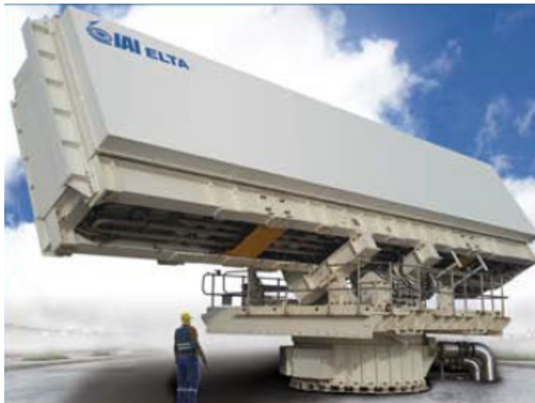
Εικόνα 3: Το ραντάρ έγκαιρης προειδοποίησης ELM-2090U UHF ULTRA της ισραηλινής IAI-ELTA, το οποίο μπορεί να αποκαλύψει στόχους χαμηλού RCS και βαλλιστικούς πυραύλους σε αποστάσεις άνω των 500 km. Ανάλογα με την απαιτούμενη λειτουργία και επιδόσεις, μπορεί να αποτελείται από 1 ή 6 ή 22 στοιχεία (cluster). Στην εικόνα φαίνεται το σύστημα C6, με 6 στοιχεία ( www.iai.co.il ).
