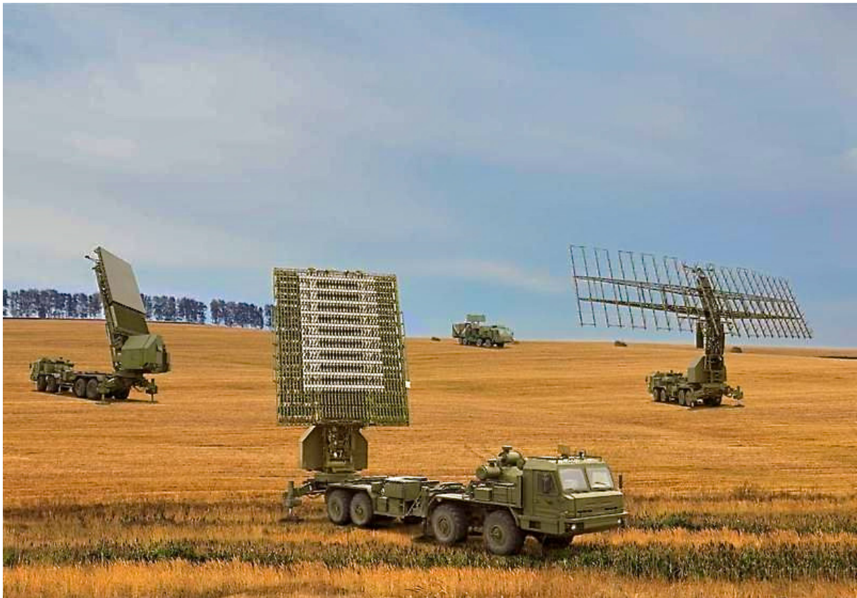
Εικόνα 5: Το ρωσικό σύστημα NEBO-M το οποίο περιλαμβάνει 3 διασυνδεδεμένα ραντάρ, στις μάντες VHF, L και S/X, καθώς και έναν σταθμό σύντηξης δεδομένων. Ο συνδυασμός 3 ραντάρ σε διαφορετικές συχνότητες επιτρέπει αυξημένες δυνατότητες αναγνώρισης στόχου, προφανώς χωρίς IFF ( https://www.rt.com/news/233959-russia-deploys-nebo-radars/ )
