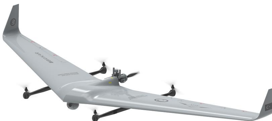
Εικόνα18. ΤοBayraktar DIHA της Baykar: ένα μικρό αεροπλάνο κάθετης απο/προσγείωσης, μέγιστου βάρους 50 kg. Μετά την απογείωση με την βοήθεια των 4 ηλεκτρικών κινητήρων του, τίθεται σε λειτουργία πλεύσης, όπου λειτουργεί μόνο ο κινητήρας εσωτερικής καύσεως, με μέγιστη ταχύτητα 80 knots και μέγιστο ύψος
