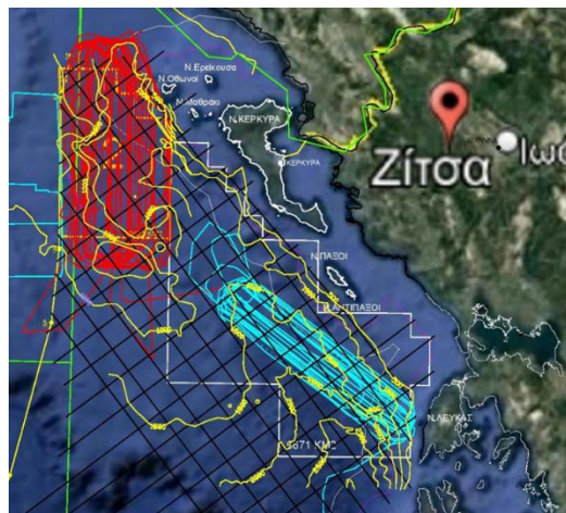
Σχήμα 14: Σεισμικό πρόγραμμα τριών διαστάσεων (3D) στα θαλασσοτεμάχια «Ιόνιο» και «2» σε συνδυασμό με το πρόγραμμα της PGS (μαύρες γραμμές)
